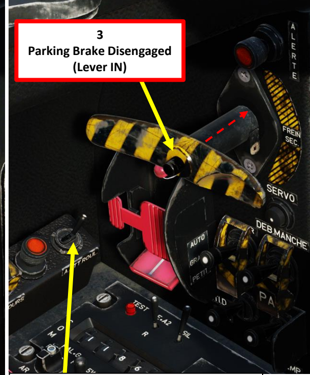
Landing Light Control Switch • FWD: ROUL (Roulage), Taxi Light • MIDDLE: ATT (Atterrissage), Landing Light • AFT: Arrêt (OFF)
